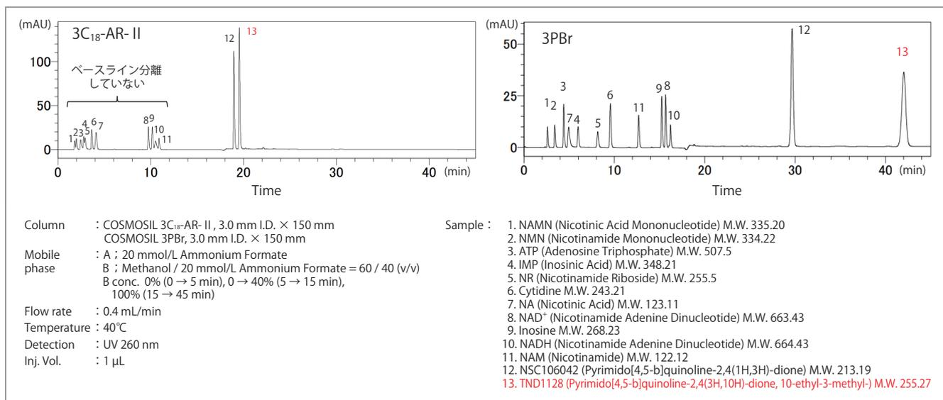
コスモシール PBr カラムを用いることで、親水性が高い 11 種類のニコチンアミド代謝物と 2 種類の 5-デアザフラビン類を、簡単なグラジエント条件で一斉分離することができました。また、移動相にはギ酸アンモニウムを使用しているため、LC-MS の分析にも適用可能です。
