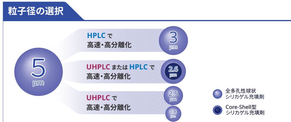
図 4. 粒子径によるカラム選択フロー
