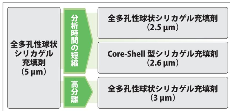
図 4. 粒子径によるカラム選択フロー
